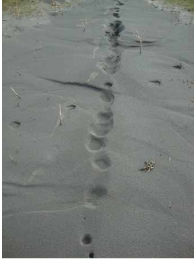
Şekil 2.13. Sıvılaşma örneği (Topaktaş Köyü – Karasu kıyısı).
