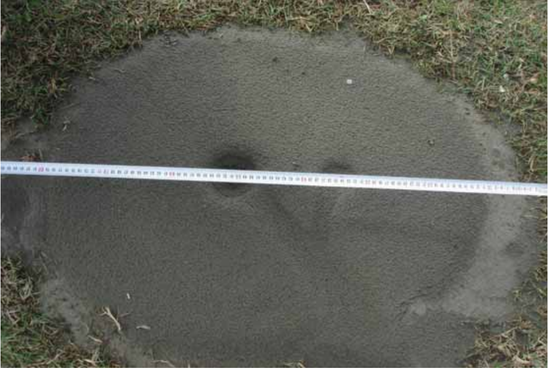
Şekil 2.14. Sıvılařma ve kum tepciđi örneđi (Topaktař Köyü-Karasu kıyısı).
